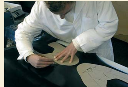
Die Schnitte werden auf das hochwertige Microfaser-Material übertragen.
